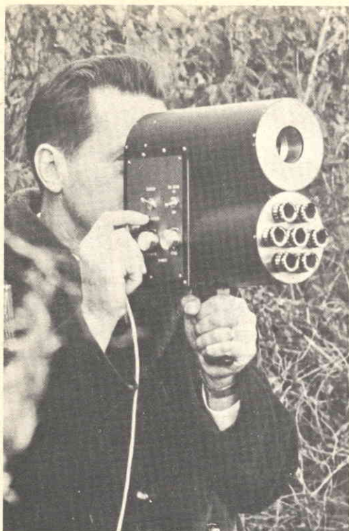
Questo sistema di rivelazione impiega un laser ad impulsi all'arseniato di gallio ed un tubo d'osservazione per la conversione dell'immagine per trovare obiettivi a 100 m di distanza nella completa oscurità. Esso viene costruito negli Stati Uniti dai Laser Diode Laboratories.
